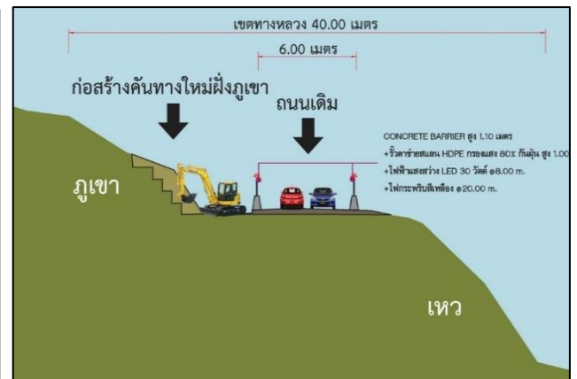
2. รูปตัดเตรียมพื้นที่ก่อสร้างทางป่าและปรับแต่งระดับก่อสร้างถนนเดิมยังสัญจรได้ปกติ แต่ช่องจราจรจะแคบลง
