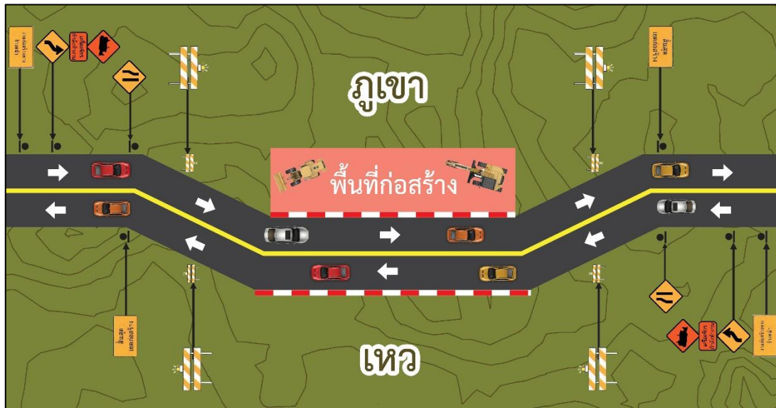
รูปที่ 5.4.8-5 แผนผังถนนเดิมและแผนผังการก่อสร้างถนนใหม่ฝั่งภูเขา (ทางซ้ายทาง)
